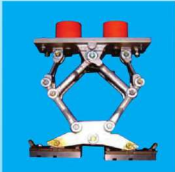
Pantógrafo vertical articulado com rolamentos
