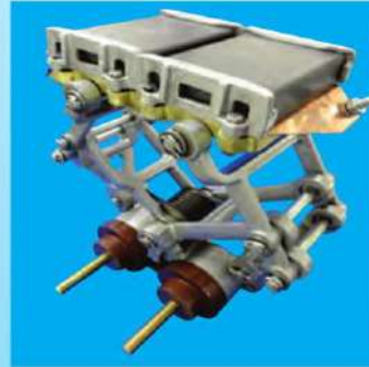
Pantógrafo horizontal articulado com rolamentos
